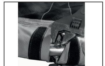
⑫ Benutzen Sie einen Schraubenschlüssel zum Festziehen der Schraubenmutter
